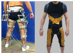
● 歩行アシスト機器・モータ駆動タイプ(左図)と受動的ゴム駆動タイプ(右図)
