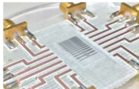
図2 作製した12チャンネルSAWフィルタ
