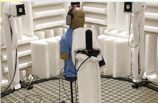
音響再現のための収録実験
