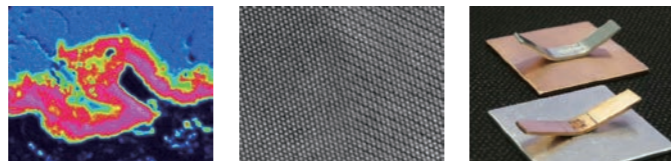
TBC界面酸化物の酸素マップ 透過型電子顕微鏡によるTBCの原子構造解析(Zrの原子配列) 異種材料の超音波接合例(Cu-Alの場合)
