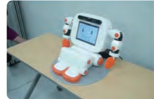
スマートデバイスを装着するロボットパートナー スマートデバイス内蔵のカメラで人間の動作や行動を認識しながら、情報支援や見守りを行います。
