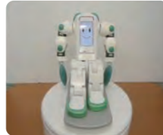
スマートデバイスを装着するロボットパートナー スマートデバイス内蔵のカメラで人間の動作や行動を認識しながら、情報支援や見守りを行います。
