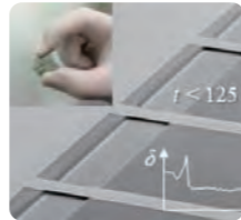
MEMS(メムス)とは「微小な電気機械システム=Micro Electro Mechanical Systems」の略称。半導体のシリコン基板・ガラス基板・有機材料などに、機械要素部品のセンサ・アクチュエータ・電子回路などをひとまとめにしたミクロンレベル構造を持つデバイスを指します。
