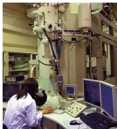
分子も見分けることが可能な最新の透過型電子顕微鏡
