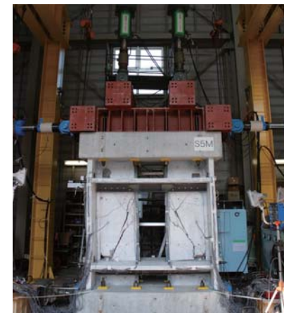
既存ストックの改修にかかわる耐震補強の実験
